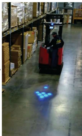
ลักษณะการกระพริบของไฟเตือนรุ่น PXS-27BF
